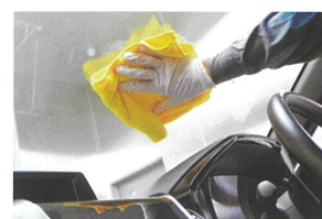
⑤内窓ガラスの清掃
